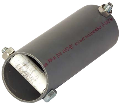
Abb. 7: Haarhafröhre zum Nachweis von Kleinsäugerarten (Bild: Blatt/Resch).
